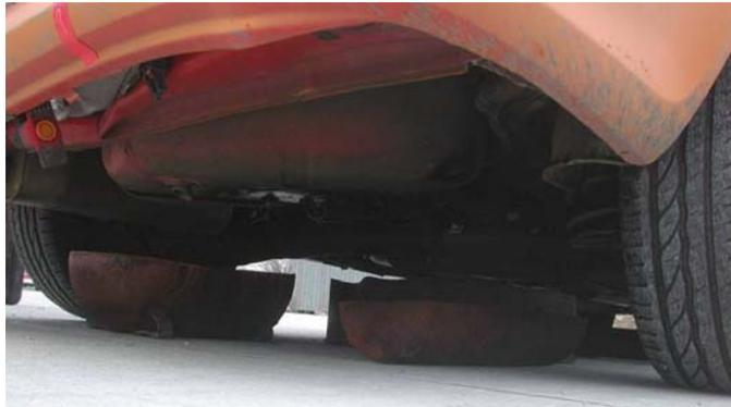
Figura 7: bandejas llenas de gasolina debajo del vehículo.
